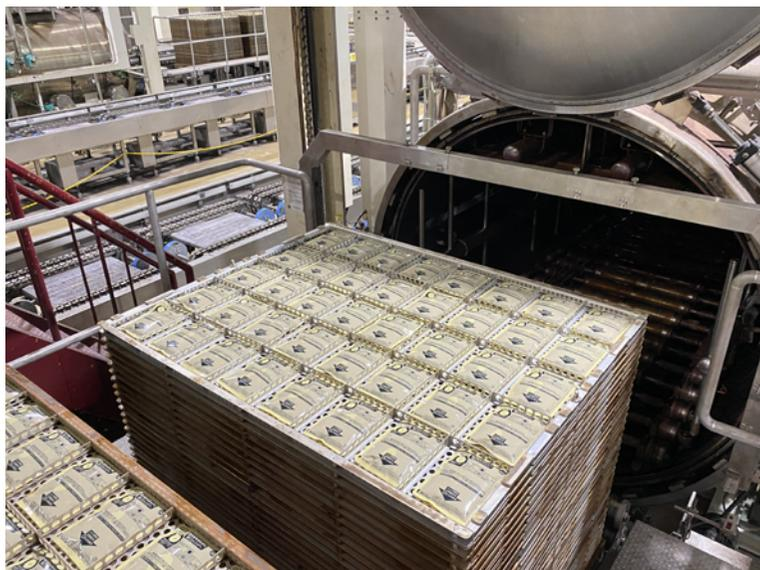
パウチは「レトルト釜」と呼ばれる大きな釜で、熱と圧力をかけて殺菌、最後に冷却されます。
